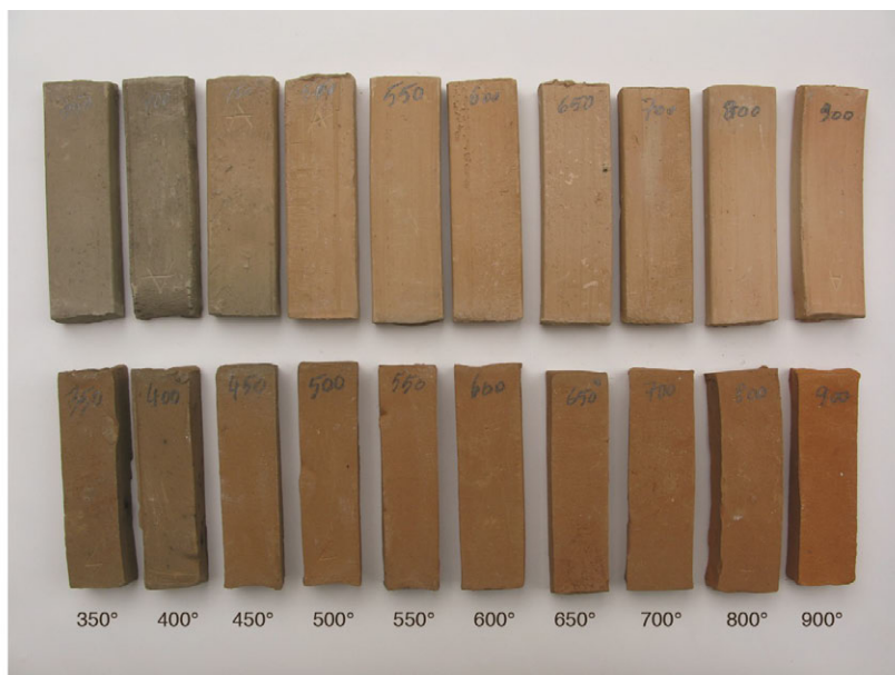
Fig. 2 - Eprouvettes réalisées avec deux types d'argiles prélevées dans la ZAC de Saint-Jorioz, à proximité du site archéologique et cuites à des températures comprises entre 350 et 900° C.
